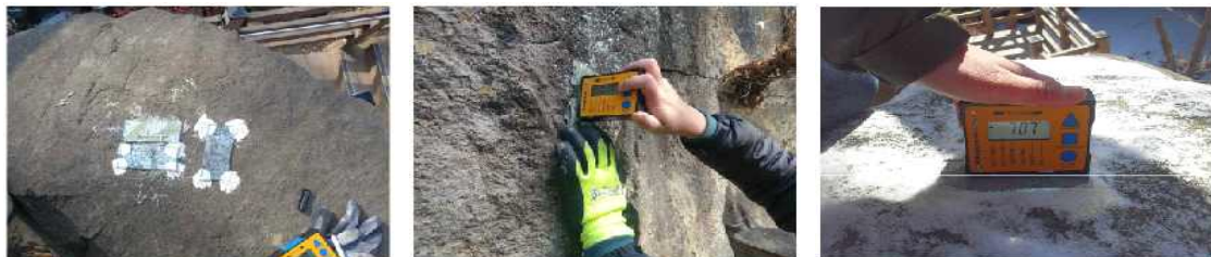
그림 C-2. 한탄강지질공원 내 분포하는 주상절리의 변위 계측 모니터링
