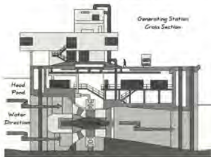
[그림 7-24] 조력발전 단면도 및 원리
