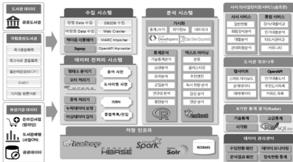
[그림 3-28] 공공도서관 빅데이터 분석시스템 개념도
