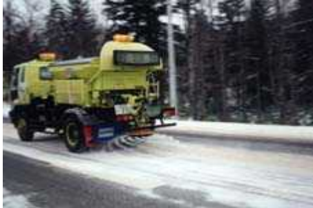
<그림 3-12> 제설제 분무 특수차량의 모습
