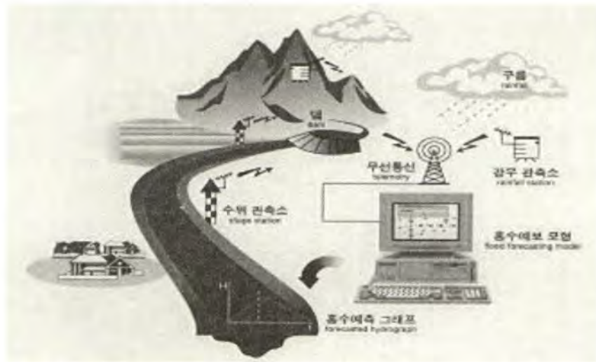
그림 5.7 안양천 및 지류하천의 홍수예경보 시스템 모식도
